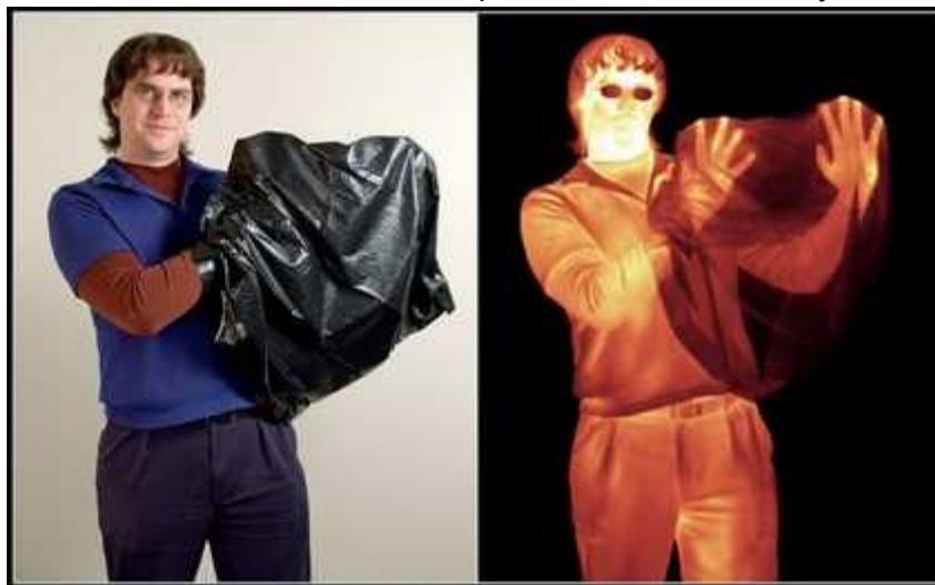
La même scène dans le spectre visible et dans l'infrarouge à grande longueur d'onde. Notez que le sac en plastique est opaque à la lumière visible mais presque transparent à l'infrarouge (avec l'aimable autorisation de l'équipe du télescope infrarouge Spitzer de la NASA).
