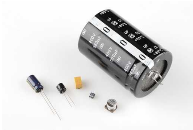
Un assortiment de condensateurs électrolytiques traversants et montés en surface. Notez que chacun a une méthode pour marquer la cathode (fil négatif).
