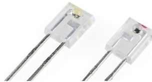
Paire émetteur/détecteur infrarouge. Peu coûteux, mais extrêmement sensible aux interférences de la lumière visible et infrarouge de l'environnement.
