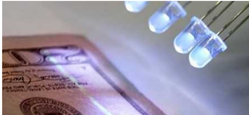
Fonctions anti-contrefaçon sur un billet de 20 $ US révélées par une LED UVA de 400 nm.
